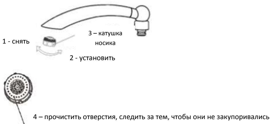
Чистка фильтра для воды: Если через какой-либо время после начала эксплуатации напор воды слабеет, следует снять и прочистить фильтр согласно рекомендациям ниже, затем вновь собрать его.
